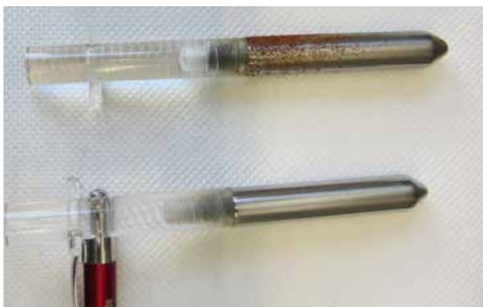
Korrosionsschutzeigenschaften gegenüber Stahl nach DIN ISO 7120: ADDINOL EcoShield HF-FR (unten) erreicht auch im Verfahren B beste Werte.
