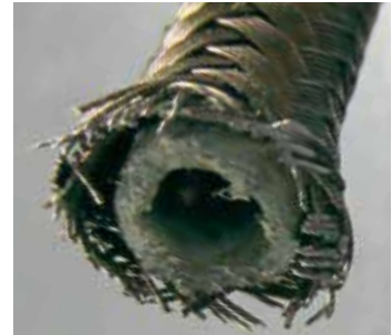
ADDINOL Cliptec XHS 280 Schmierstoffzuleitung ohne Ablagerungen, voll durchgängig
