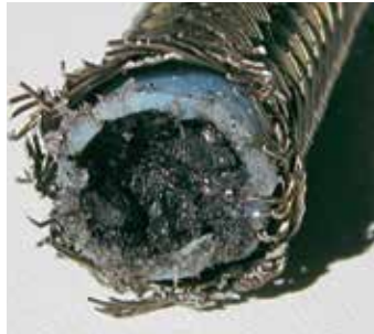
Wettbewerbsprodukt Schmierstoffzuleitung durch Ablagerungen blockiert
