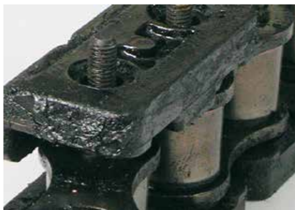
Kettenelement mit Schwarzbelag nach ca. 21.000 Betriebsstunden mit einem Wettbewerbsprodukt
