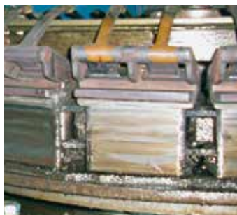
Wettbewerbsprodukt Kette mit Ablagerungen und Verkrustungen auf der Gleitfläche
