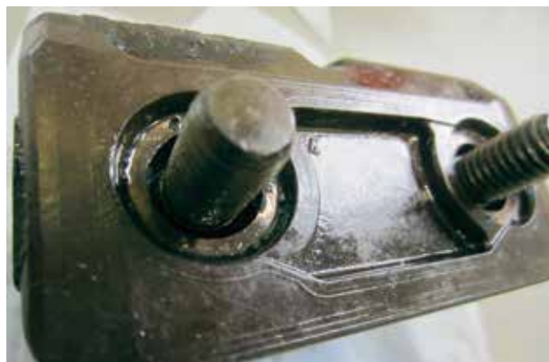
Kettenelement ohne Ablagerungen nach ca. 18.500 Betriebsstunden mit ADDINOL Cliptec XHS 280
