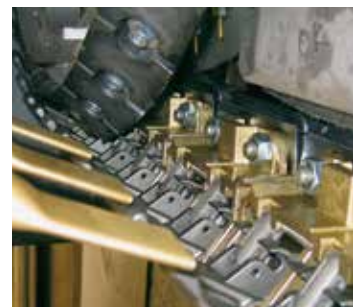
ADDINOL Cliptec XHS 280 Saubere Kettenglieder ohne Verkrackungen oder Rückstände
