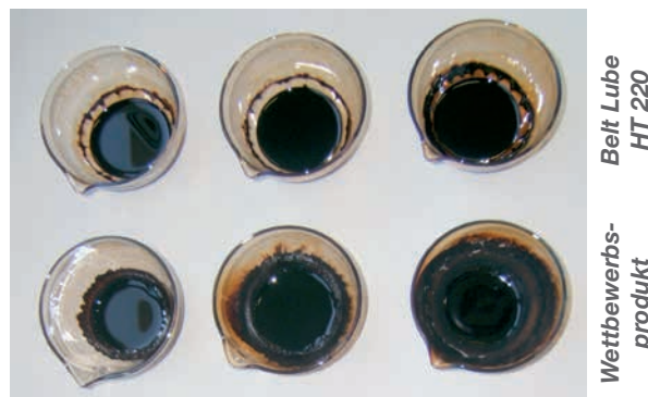
Abbildung 4: Simulation des Ablagerungsverhaltens mittels Schälchentest bei verschiedenen Temperaturstufen
