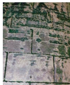
Ablagerungen auf den Reibbelägen der Umlenkrolle vor Umstellung auf ADDINOL Belt Lube HT 220
