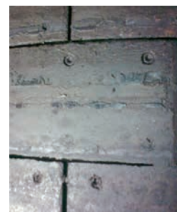
Deutliche Reduzierung der Ablagerungen auf den Reibbelägen ca. 6 Monate nach Umstellung auf ADDINOL Belt Lube HT 220
