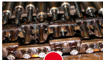
Ablagerungen und Verkrustungen an Kettenkomponenten mit Wettbewerbsprodukt
